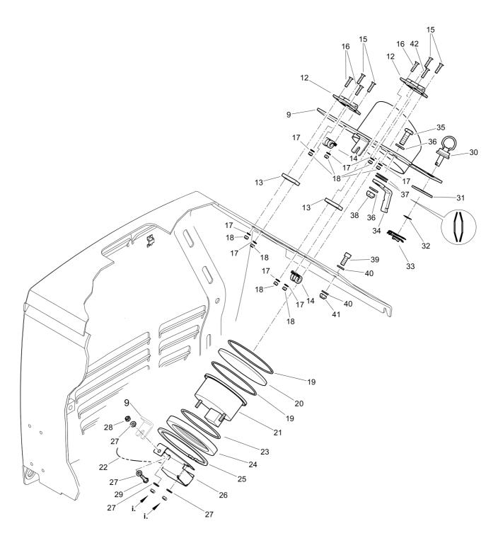
i. = Rändelmutter handfest anziehen (max. 0,8 Nm)= Tighten the knurled nut finger tight (max. 0,8 Nm)
