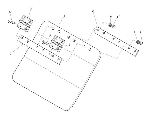
1) Anziehdrehmoment 3 Nm Tightening torque 3 Nm
